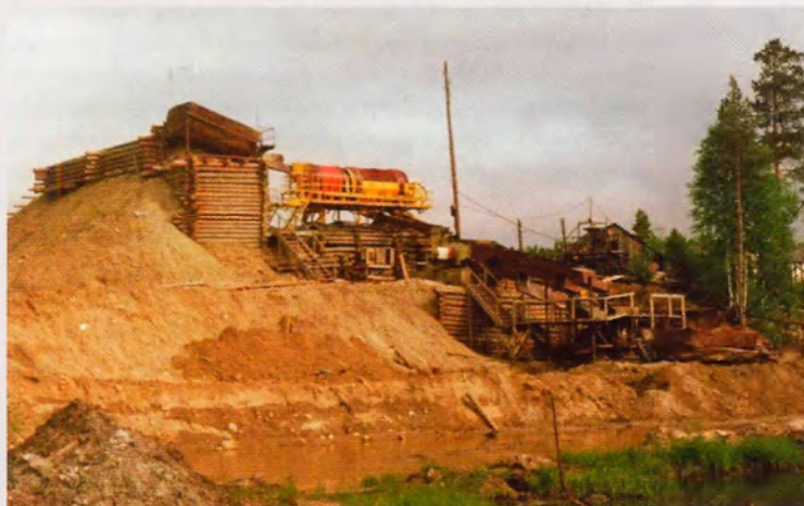
Рис. 4. Опытная фабрика для выделения полезных компонентов из продуктивных конглобрекций проявления Ичетью
