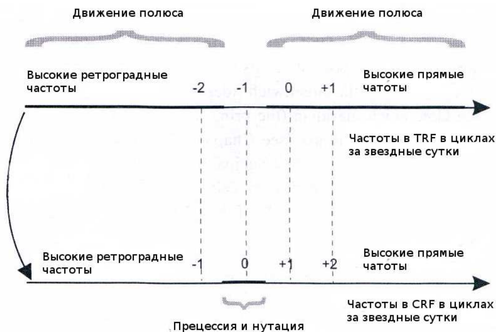
Рис. 1.3: Соотношение между частотами движения промежуточного небесного полюса CIP в земной TRF и небесной CRF системах координат [161].
