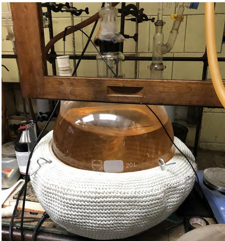
Рис 37. Проведение эксперимента по каталитической олигомеризации децена-1. Объем реакционной колбы 20 л.
