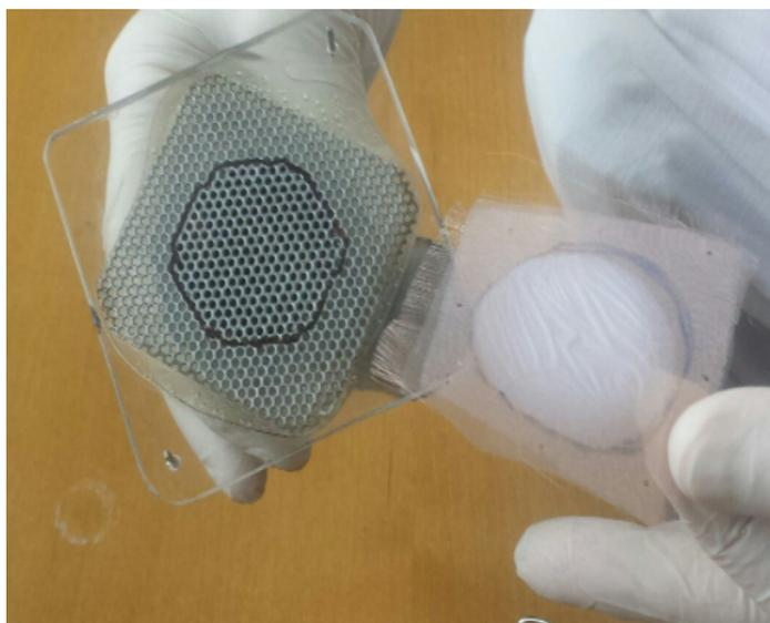
Рисунок 8 – Внешний вид комплекта для сбора аэрозольных образцов с использованием нейлонового нанофильтра производства ИТЭБ РАН (Россия).
