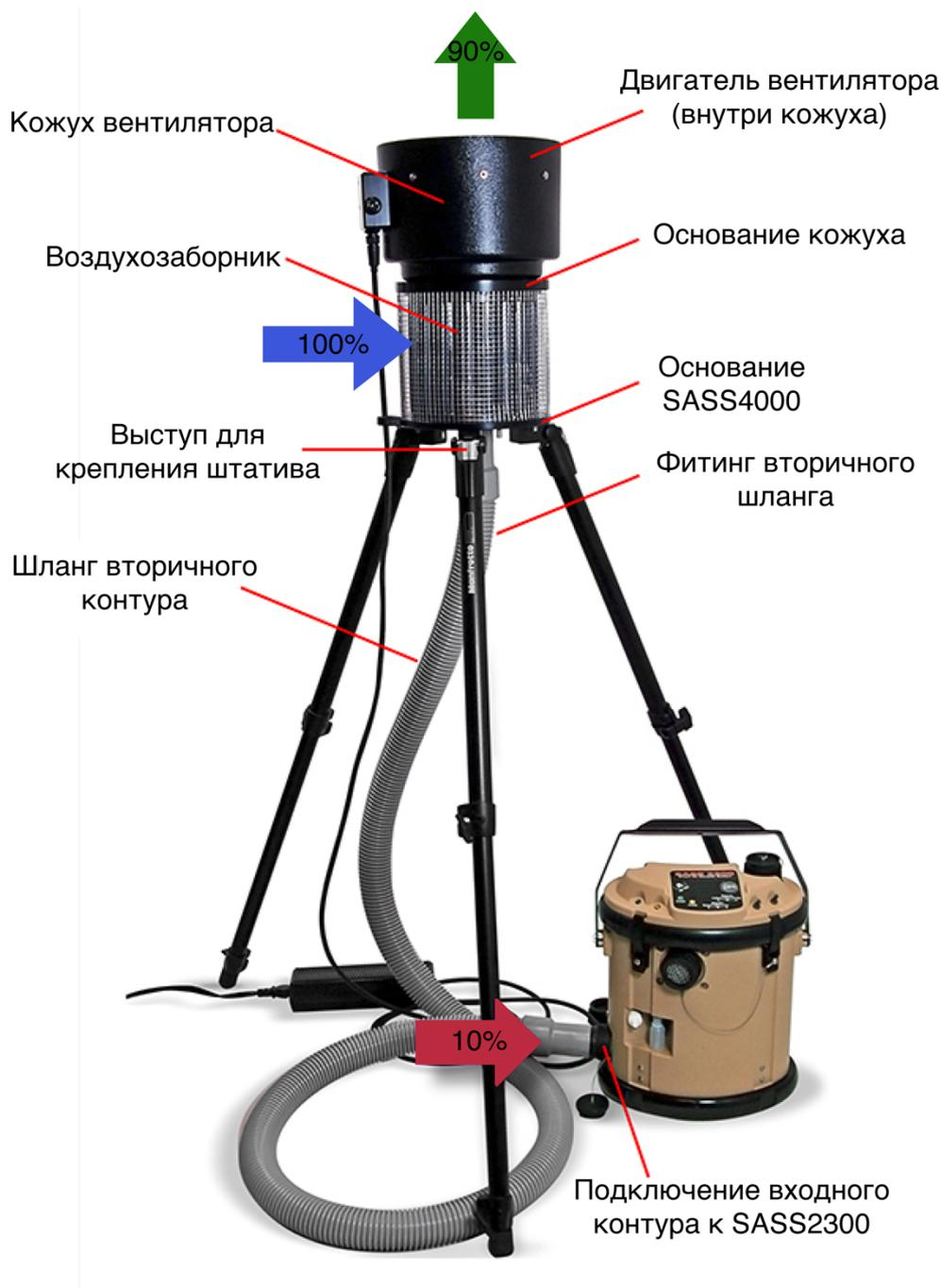
Рисунок 11 – Внешний вид двухстадийной системы сбора аэрозоля SASS 4000/SASS 2300 в полевом варианте производства SASS (Research International Inc., США). Адаптировано из [181]
