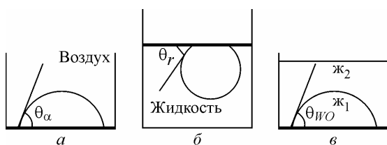
Рис. 1. Схема измерения краевых углов в условиях натекания (а), оттекания (б) и избирательного смачивания (в)
