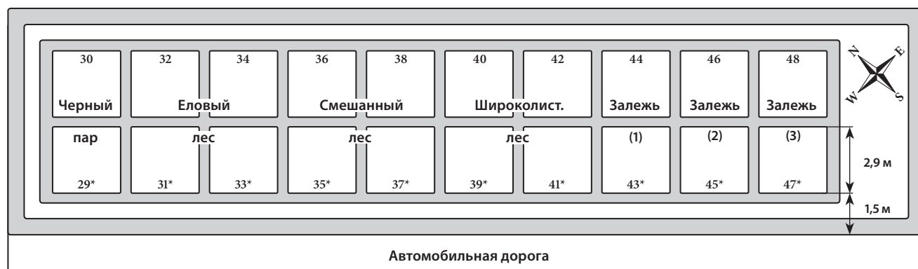
Рис. 1. Схема лизиметрической площадки.
