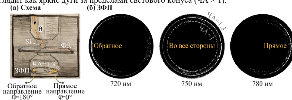
Рис. 1. Направленное возбуждение БПВ с помощью ми-резонансных частиц: а – схема эксперимента, б – изображения ЗФП для различных длин волн возбуждения для кремниевой частицы диаметром 210 нм. Яркая дуга в ЗФП в диапазоне ЧА ∈ [1; 1.3] соответствует БПВ.
