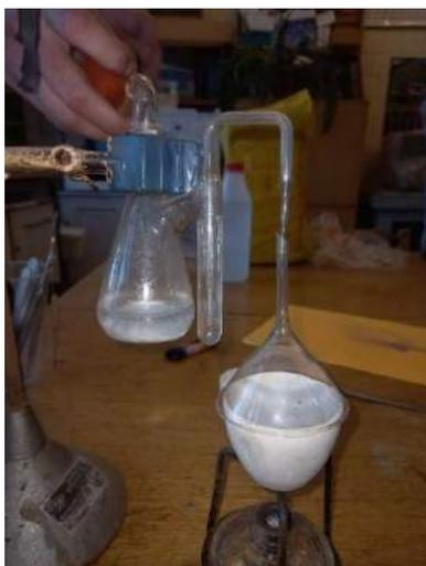
Рисунок 1. Экспериментальная установка с нагревом и газоотводной трубкой для наблюдения выделения диоксида серы при обжиге полиметаллических сульфидных руд.
