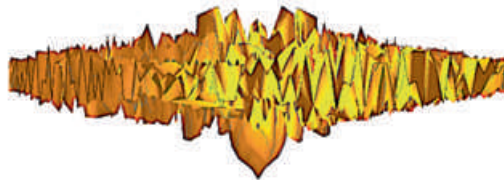
Рис. 1.3. Схематическое представление ППЭ, имеющей огромное число критических точек (минимумов, максимумов, седловых точек различного индекса)
