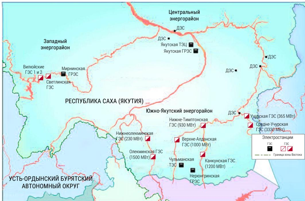
Рис. 4. Схема Южно-Якутского гидроэнергетического комплекса
