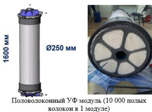
Рисунок 2. Примеры разработанных мембранных модулей
