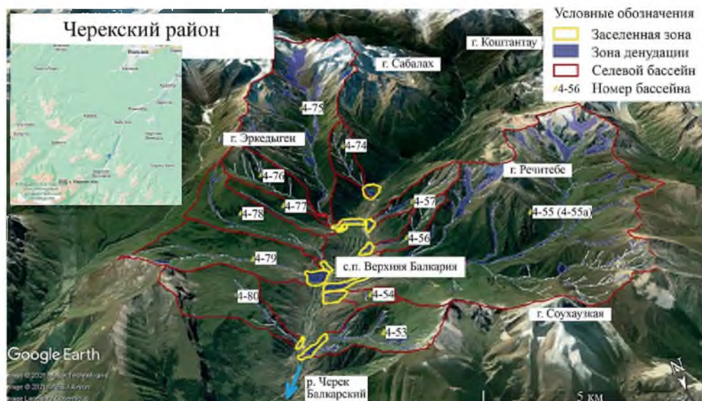
Рис. 1. Электронная карта-схема селевых бассейнов, угрожающих с.п. Верхняя Балкария
