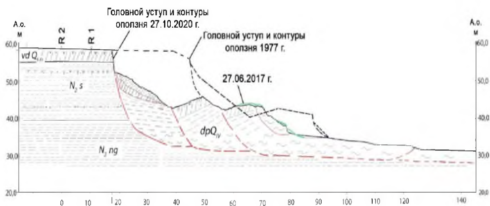
Рис. 4. Геолого-геоморфологический профиль через оползень в 1,0 км севернее ст. Малая Лучка. Октябрь 2020. Условные обозначения к Рис.2.
