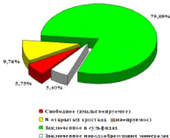
Рис. 4. Формы нахождения золота в технологической пробе рудопроявления «Траншейное» (Аналитический центр ЦНИГРИ, 2016)
