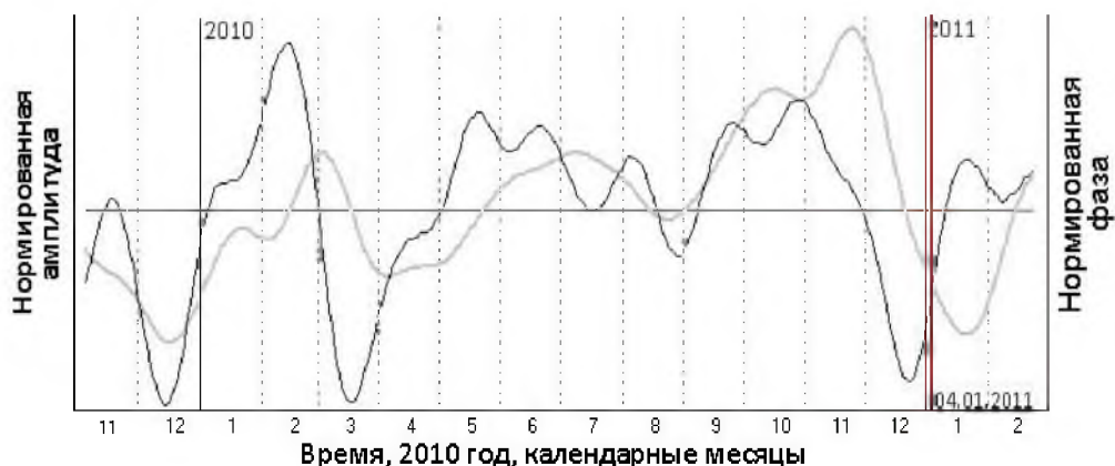
Рис. 3. Совмещённые нормированные графики амплитудного ( Re(W) – серая линия) и фазового ( Im(W) – чёрная линия) параметров за период с ноября 2009 по февраль 2011 г. Вертикальными линиями отмечены – начало 2010 и 2011 гг. и момент землетрясения 04.11.2011 г.
