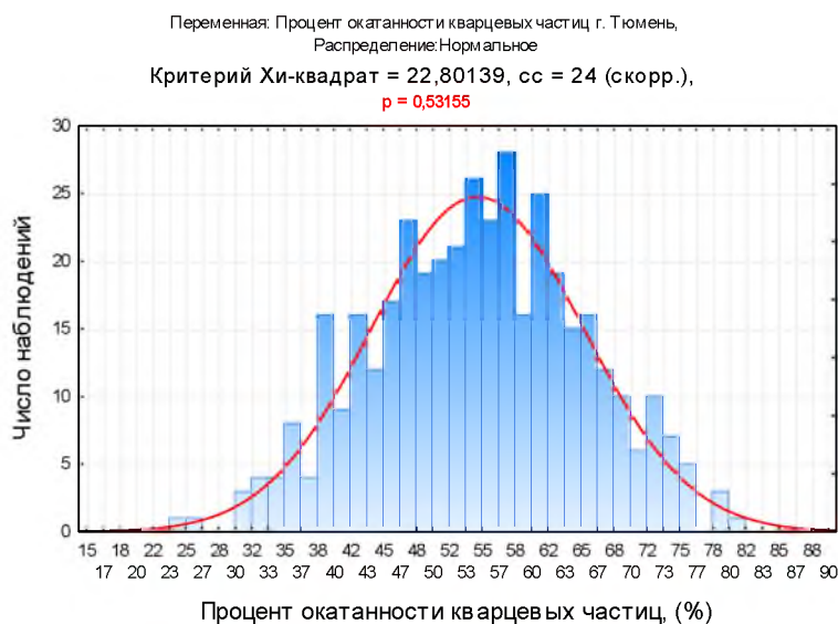
Рис. 4. Частотная гистограмма распределения частиц по проценту окатанности для проб осадка. Критерий Chi-Square на нормальное распределение
