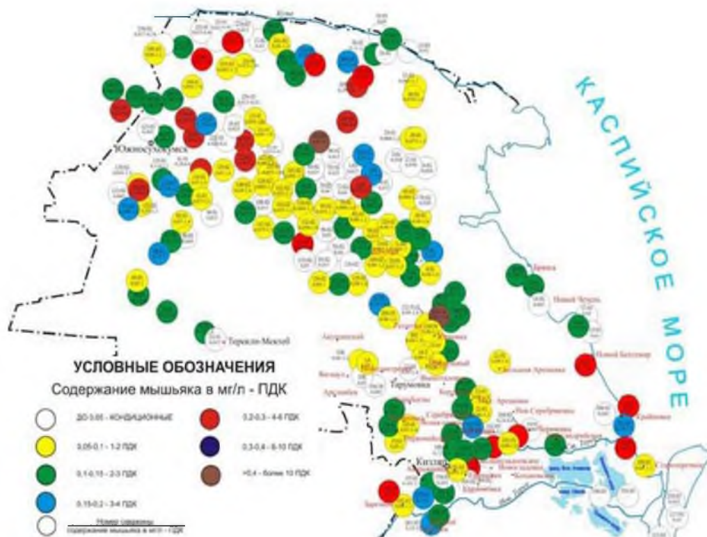
Рис. 4. Обзорная карта содержания мышьяка в подземных водах СДАБ (Курбанов М.К.)
