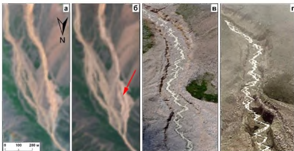
Рис. 2. Участок окончания верхнего моренного каньона р. Каяартысу и поля селевой аккумуляции в разные годы: а – космоснимок Sentinel-2 05.08.2022, б – космоснимок Sentinel-2 10.08.2022 (стрелкой показан след селя на участке поля селевой аккумуляции в виде вреза, отмеченный на фрагменте «г»), в – вертолётный снимок М.Д. Докукина 10.07.2018, г – фото с квадрокоптера 09.08.2022
