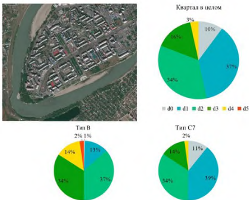
Рис.4. Распределение степеней повреждения зданий разных типов в микрорайоне Юбилейный
