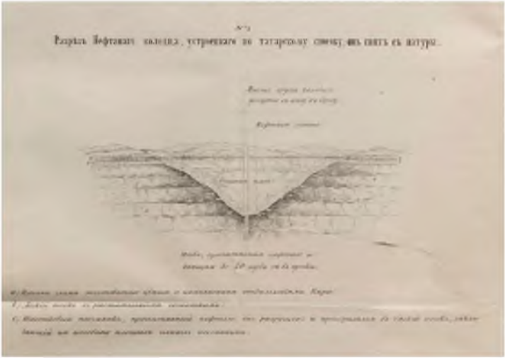
Рис.1. Разрез нефтяного колодца [2]
