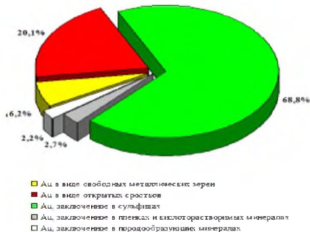
Рис. 3. Формы нахождения золота в технологической пробе рудопроявления «Мукеркам-1» (Аналитический центр ЦНИГРИ, 2012)
