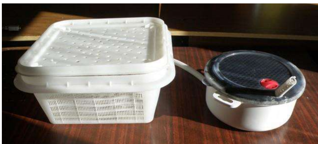
Рис. 1. Конструкции моделей гнезд-инкубаторов, использованных в эксперименте. Слева – прототип инкубатора, разработанного на кафедре КамчатГТУ, справа – гнездо-инкубатор «Шайба»
