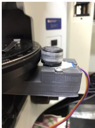
Рис. 1. Приставка автоматизированного вращения предметного столика спектрометра.
