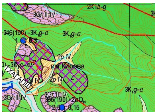
Рис. 5. Фрагмент гидрогеологической карты [Отчет ФЦП, 2007]. Бассейн реки Бжижу. Условные обозначения: 2pIV – пролювиальный голоценовый водоносный горизонт: щебнисто-глыбовые, валунные и глинисто-дресвяные отложения; 3K 1 g-a – готеривско-аптский относительно водоупорный горизонт: глины, алевролиты, песчаники; 3Gr II-IV – нерасчлененный верхненеоплесточеново-голоценовый водоупорный горизонт гравитационного комплекса отложений, сложенный дресвяно-глинистыми отложениями с включением щебня, глыб, отторженцев, глин и суглинков. Остальные обозначения см. на рис. 3
