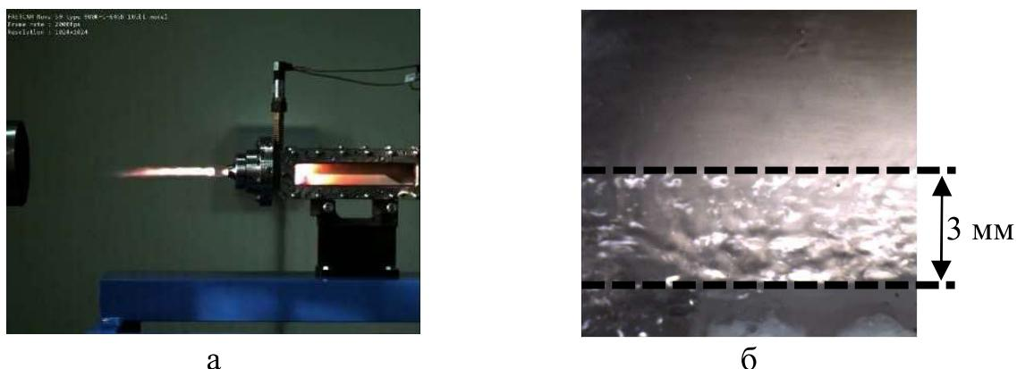
Рис. 2 – (а) Работа установки, (б) Слой расплавленного парафина (обозначен пунктирными линиями).
