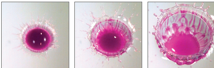
Рис. 2. Картина распределения вещества капли по поверхности жидкости в импактном режиме.
